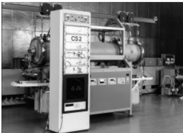
Bild 1: Caesium-Atomuhr CS2 der Physikalisch-Technischen Bundesanstalt Braunschweig (Foto: PTB Braunschweig).
